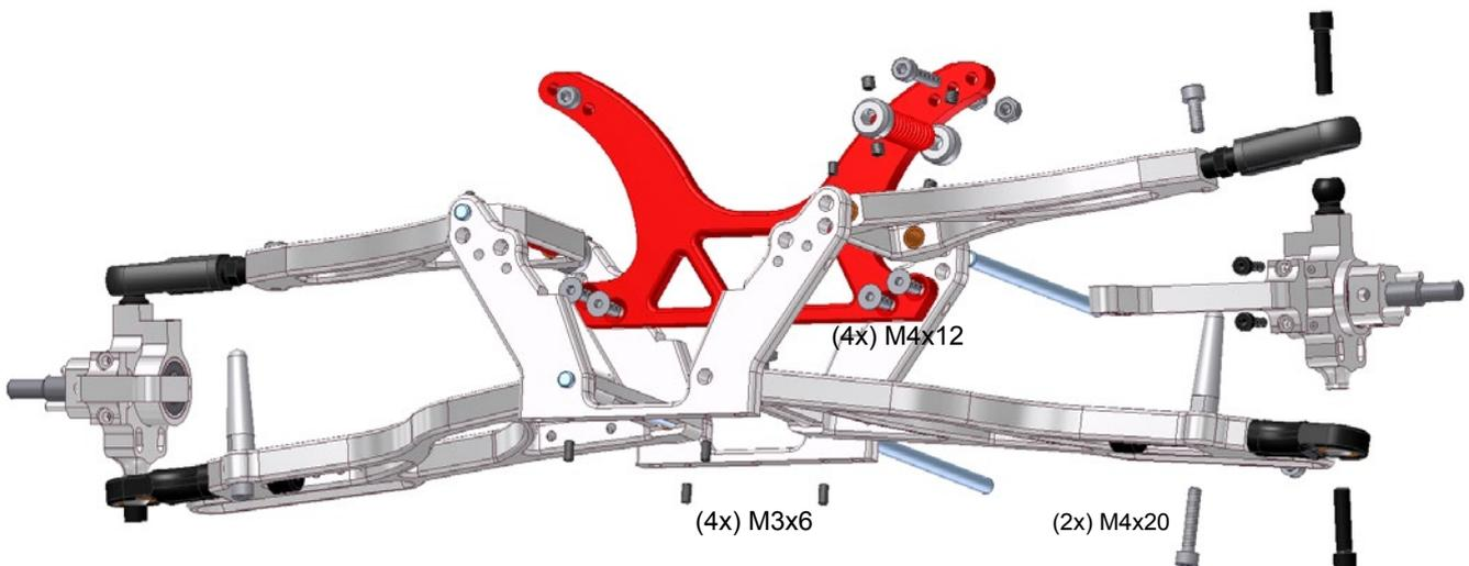
Verifica que el movimiento de los trapecios antes de montar los amortiguadores es suave en todo su recorrido sin fricciones o puntos duros.
