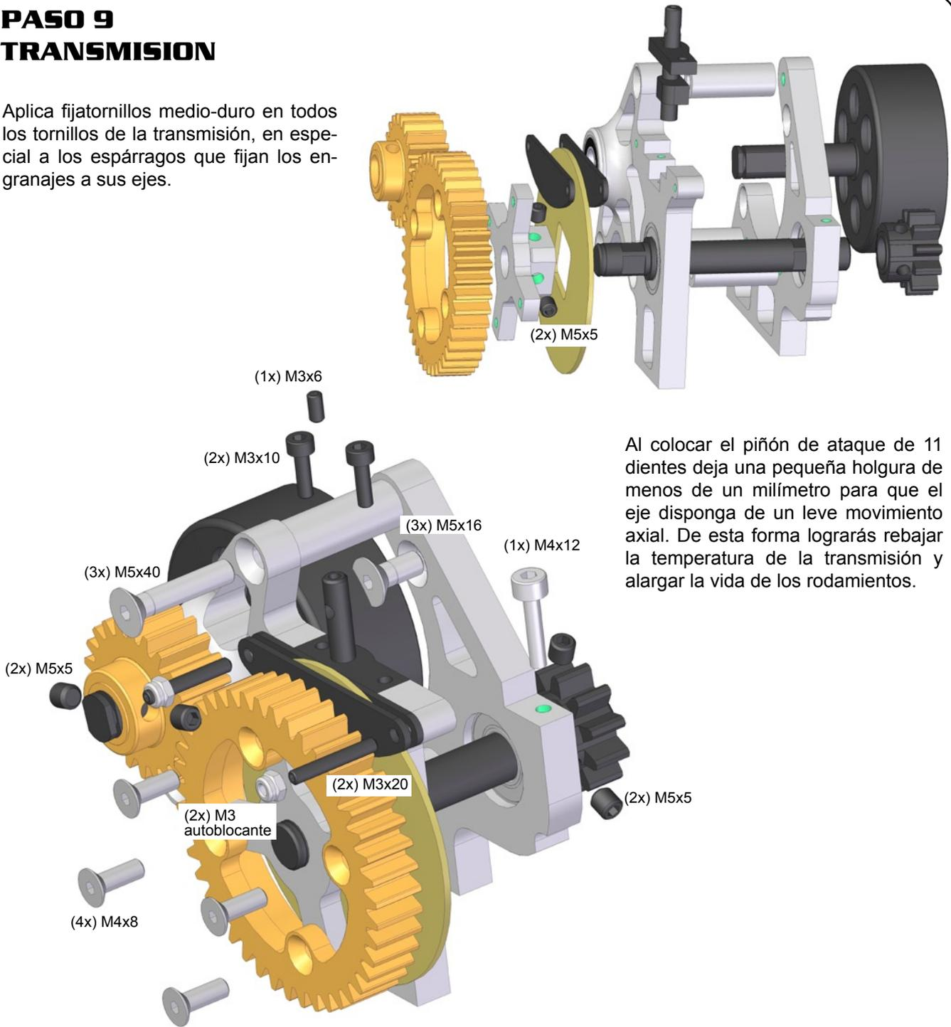
Al colocar el piñón de ataque de 11 dientes deja una pequeña holgura de menos de un milímetro para que el eje disponga de un leve movimiento axial. De esta forma lograrás rebajar la temperatura de la transmisión y alargar la vida de los rodamientos.
