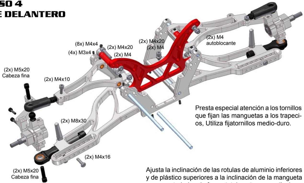
Presta especial atención a los tornillos que fijan las manguetas a los trapecios, Utiliza fijatornillos medio-duro.
