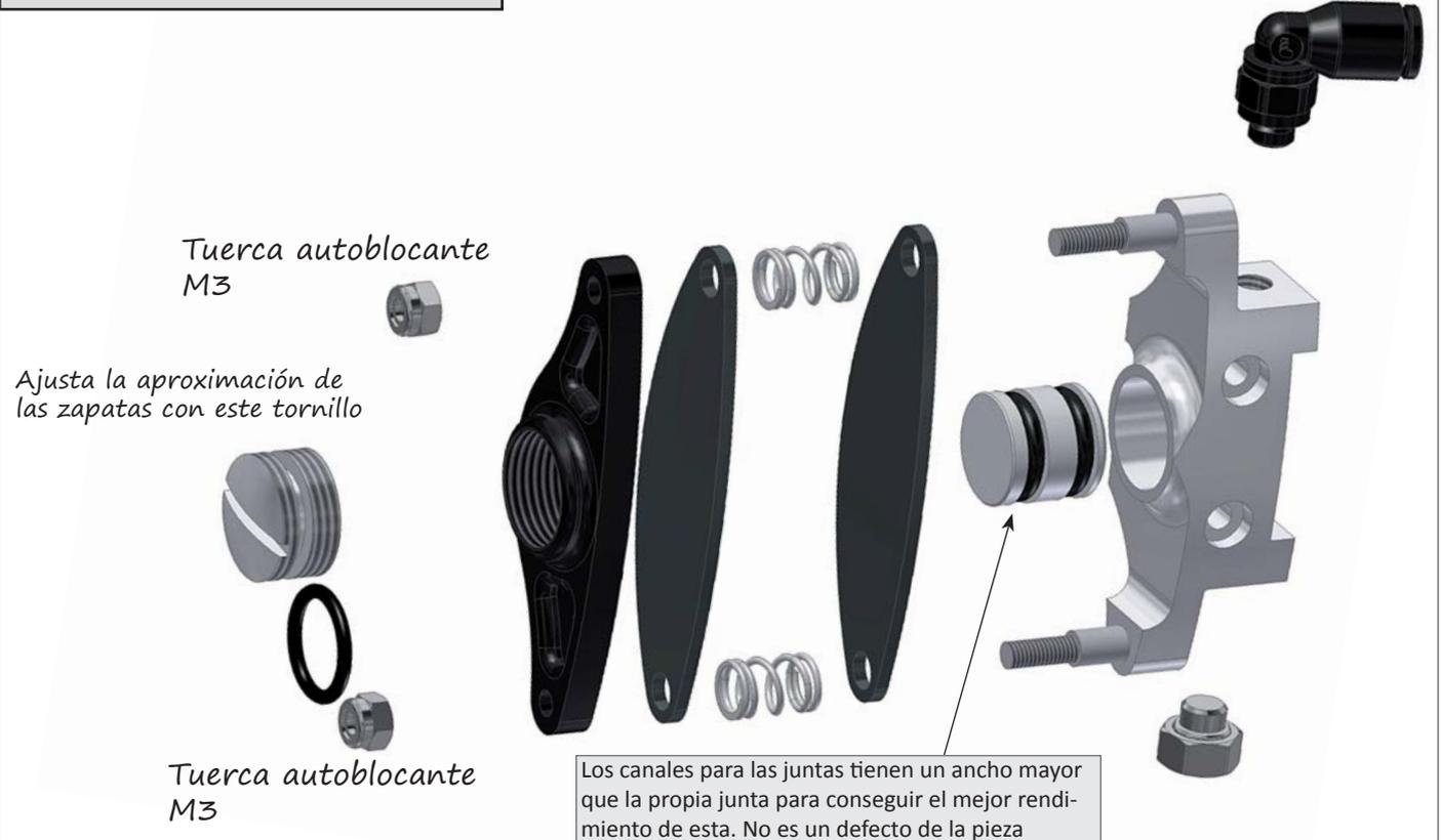
Al instalar las juntas en el pistón y al instalar el pistón en su canal aplicar un poco de grasa suave; Esto mejorará la suavidad de la pinza y alargará la vida de las juntas.
