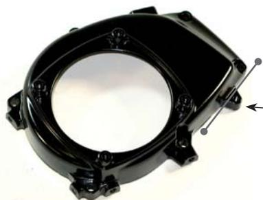
Corta esta pestaña de la cubierta de motor para permitir una instalación del escape "a la derecha" más sencilla
