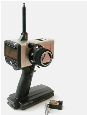
Emisora de dos o tres canales con baterías, receptor y cristal de frecuencia.
